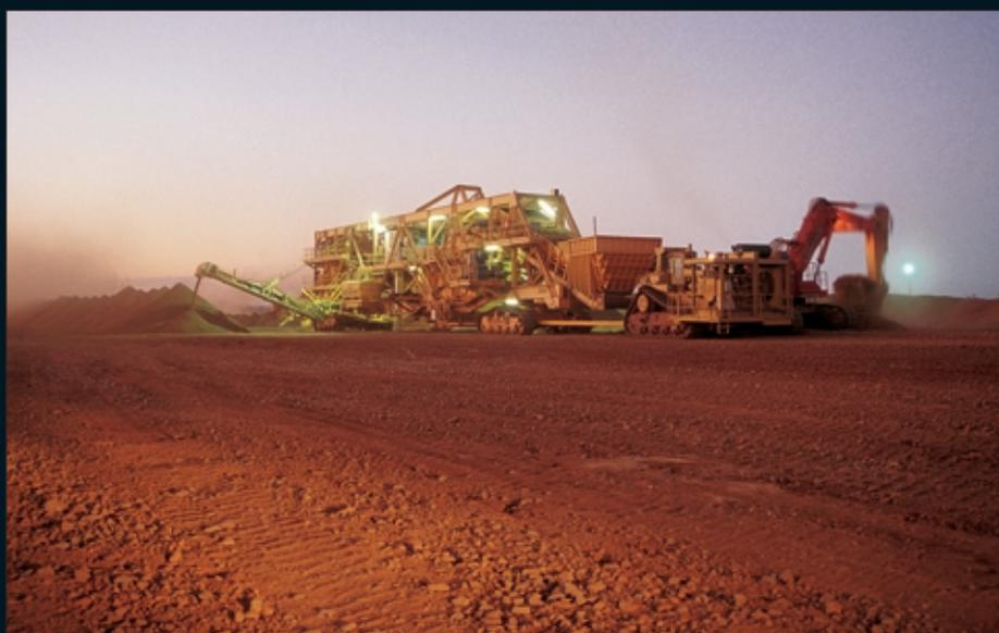
Wir nähern uns einem der großen Bagger, der die Erde entlang einer geraden Linie in eine transportierbare Industrieanlage hineinschaufelt. Die gerade Linie folgt einem alten Flußbett. Durch Verwitterungsprozesse geben die Begleitminerale ihren Gast frei, und die Diamanten werden, nachdem sie zahlreiche geologische Ereignisse überstanden haben, in Flußbetten weitertransportiert. Diese Art von Vorkommen werden sekundäre Lagerstätten genannt, die anderen, wie die „AK 1“, primäre Lagerstätten.
